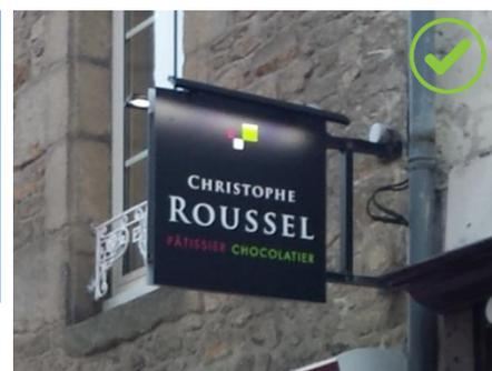
**Enseigne perpendiculaire à la façade, éclairée de façon indirecte (rampe d'éclairage)**
