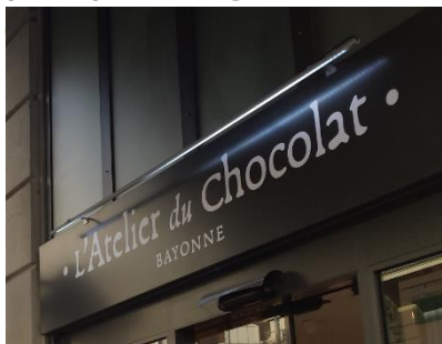
Enseigne éclairée de façon indirecte (rampe d'éclairage)
