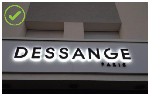
Enseigne lumineuse par rétro-éclairage (éclairage par l'arrière des lettres)
