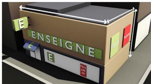
Sur chaque façade, la surface cumulée des enseignes (en vert) est comparée à la surface totale de la façade (hauteur x largeur), baies comprises. Les publicités et le microaffichage (en rouge) n'entrent pas en compte
