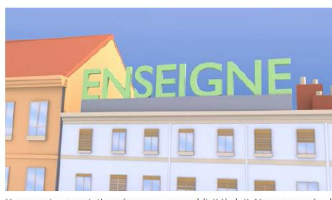
Une enseigne en toiture (comme une publicité) doit être composée de lettres découpées sans fixations visibles. Bandeau technique de 0,50 m maximum.
